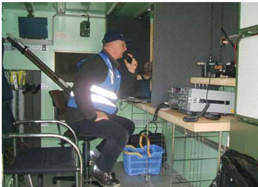
Bild 2 Der Anhänger des Notfunks Kreis Wesel ist blitzgeschützt, hochfrequenzdicht und EMP-fest.
