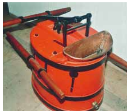
Bild 7 Holzbottich-Spritze mit Trageholmen und Einfülltrichter (Sammlung der Ostfriesischen Landschaftlichen Brandkasse in Aurich).
