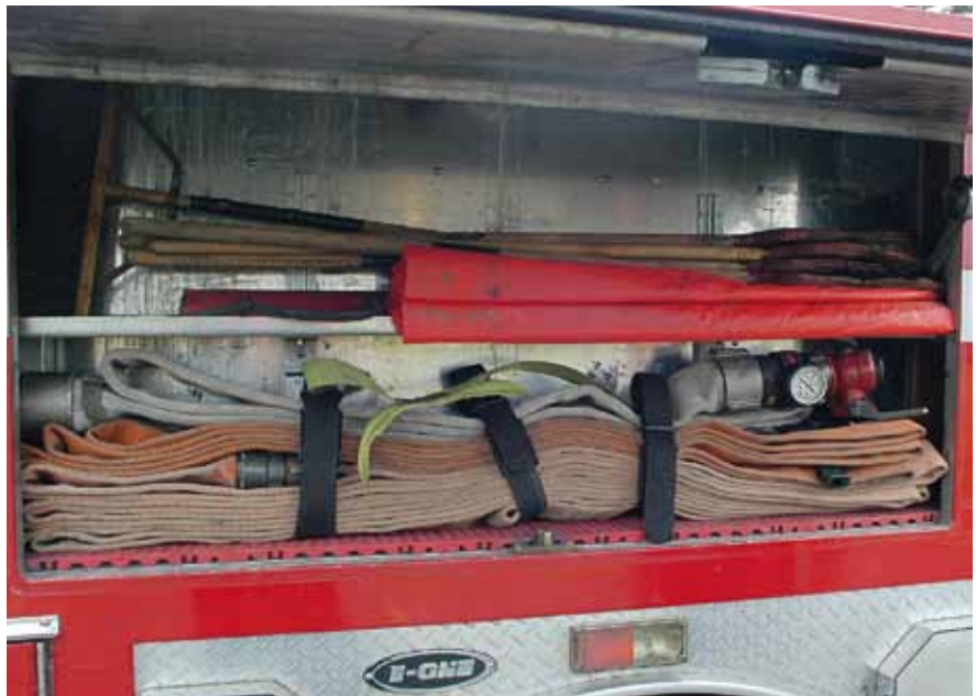
Bild 3 Schlauchpaket mit Verteiler und Hohlstrahlrohr (»high-rise pack«), Feuerwehr City of Waukesha (USA).
