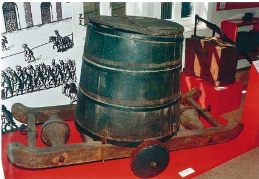
Bild 2 Löschwasser-Holzbottich auf Rädern und Kufen für Sommer- und Winterbetrieb (Göttingen : Museum am Ritterplan).
