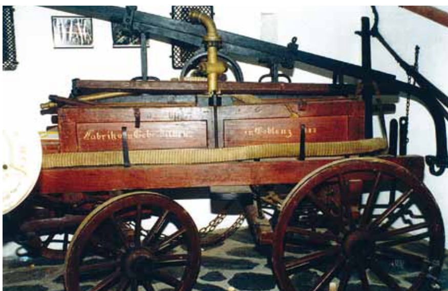
Bild 4 Diese Druckspritze von 1843 konnte nicht selbst ansaugen, sondern wurde per Eimerkette befüllt. Der Sieb-Einsatz sollte vor Verunreinigungen schützen.
