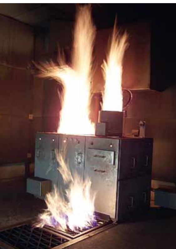
Bild 8 Flammenbild am Fuße der Flaschenbatterie und ein Feuer an den Gasflaschen.
