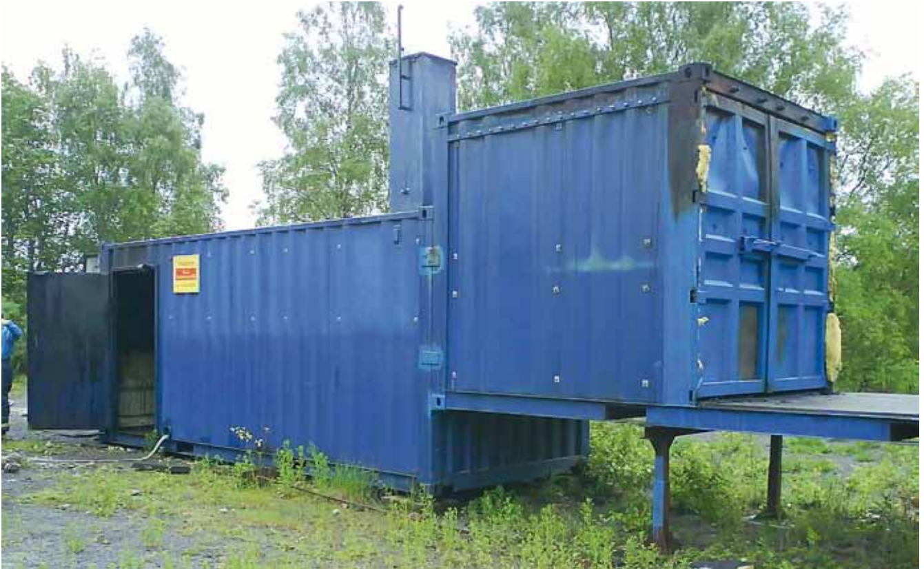
Bild 2 RDA der Feuerwehr Wuppertal (holzbefeuert).
