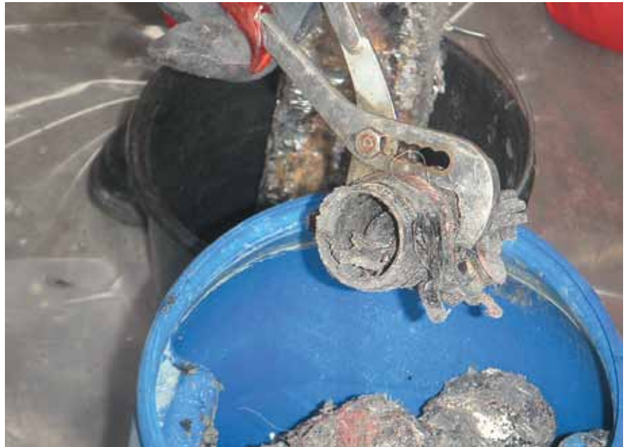
Bild 4 Detailsicht des zerstörten Ignitrons.
