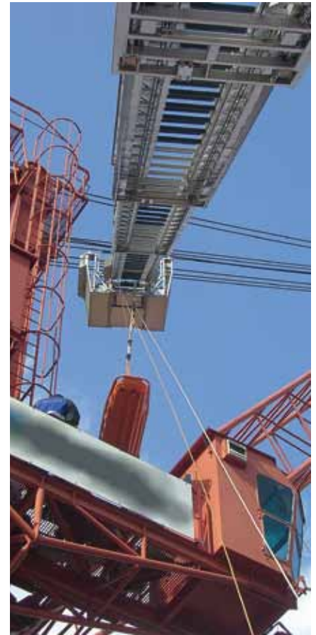
Bild 4 Personenrettung von einem Hafenkran über eine DLA (K) 23-12 mit Schleifkorbtrage, Flaschenzugsystem und Redundanzseil.
