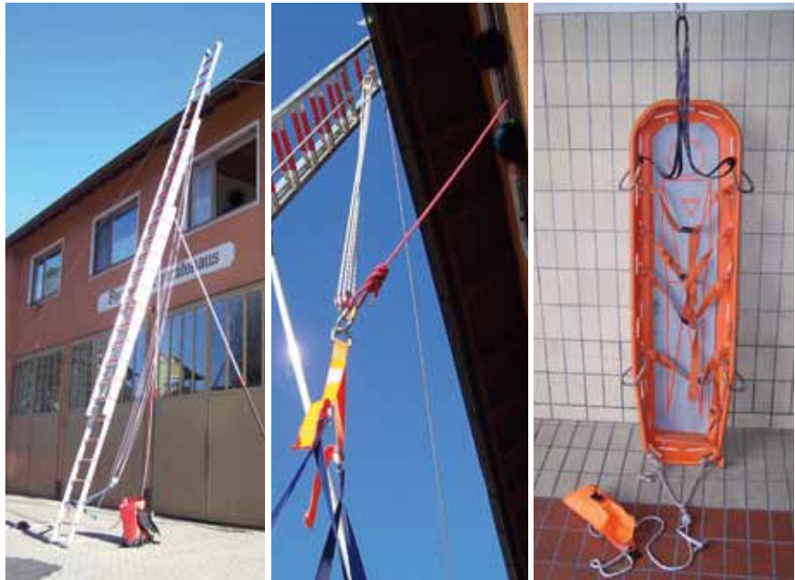
Bild 8 Aufgerichtete Schiebleiter mit eingehängtem Flaschenzugsystem und beidseitig abgespannter Leiterspitze.
