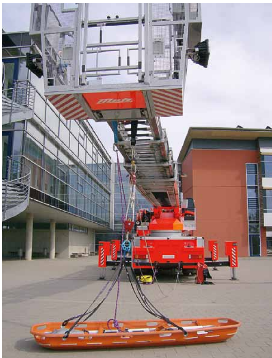
Bild 1 Einsatzbereit installiertes Flaschenzugsystem und Redundanzseil an der Leiterspitze einer DLA (K) 23-12.
