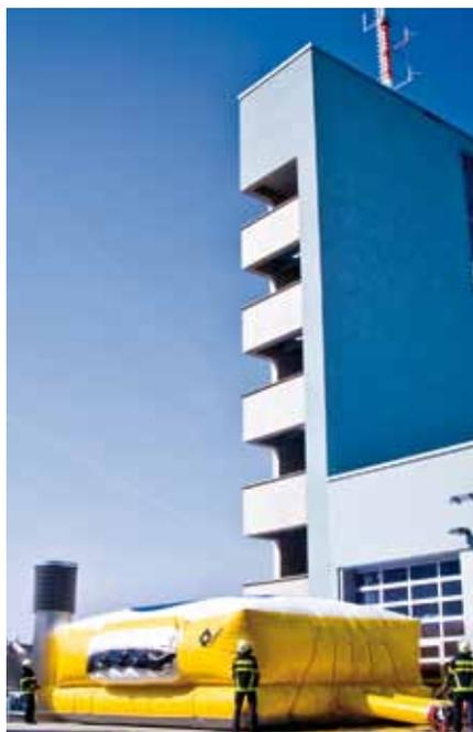
Im Messe-Freigelände auf der »Inter-schutz« 2010 wurde die Neuentwicklung bereits vorgestellt. Hier präsentierte der deutsche Hersteller Vetter ein Sprungkissen, das eine Rettung von Personen aus bis zu 60 m Höhe ermöglicht. Als Komplett-Anbieter für Notfall-Pneumatik arbeitet Vetter bei der Produktentwicklung seit über 40 Jahren eng mit Feuerwehren und
