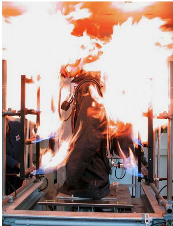
Bild: Prüfung der Beflammung
